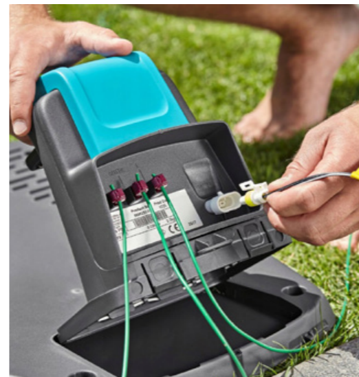
Stacja dokująca zasila przewód ograniczający obszar pracy robota koszącego.
