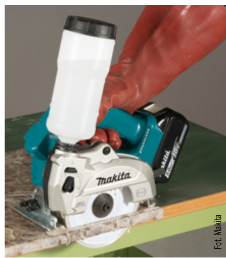
Chłodzenie wodą skutecznie chłodzi tarczę i minimalizuje powstający pył korzystając z pilarki Makita DCC501Z.
