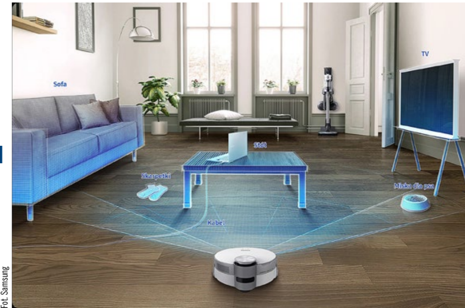
Robot odkurzający Samsung Jet Bot AI+ porusza się z dużą precyzją, rozpoznając i klasyfikując nie tylko drobne przedmioty pozostawione na podłodze, ale także urządzenia i meble.
