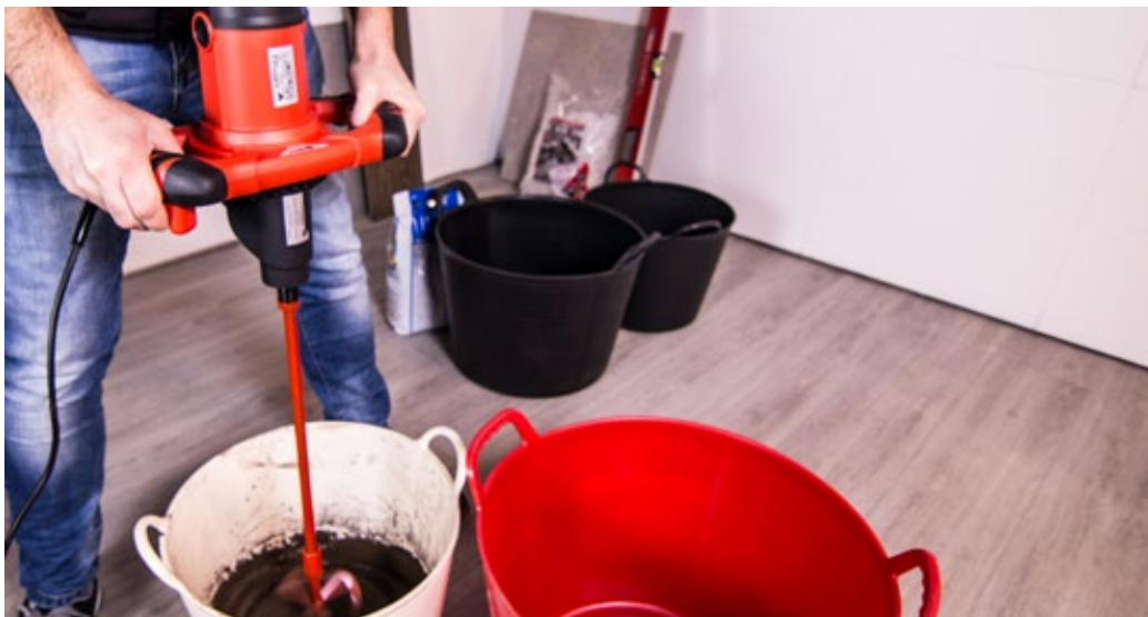
Większość dostępnych mieszarek jest wyposażona w dwustopniową przekładnię, co umożliwia dostosowanie trybu pracy do mieszanej masy.
